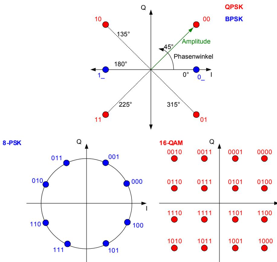
Bild 6-20 Zeigerbild für QPSK, BPSK, 8-PSK und 16-QAM inkl. Bitwerten
