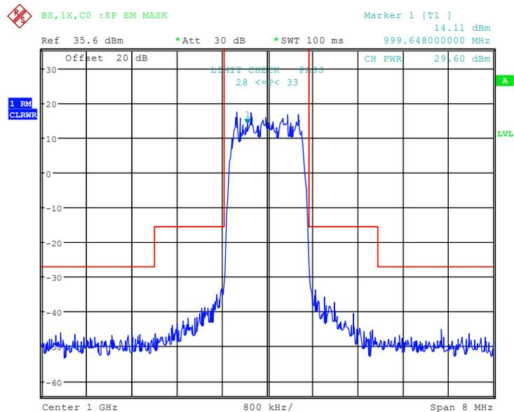
Bild 6–3 Messung der Spectrum Emission Mask.
