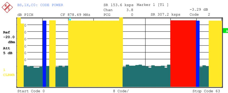
Bild 6-8 CDP-Diagramm in BitReverse-Ordnung für das gleiche Signal
