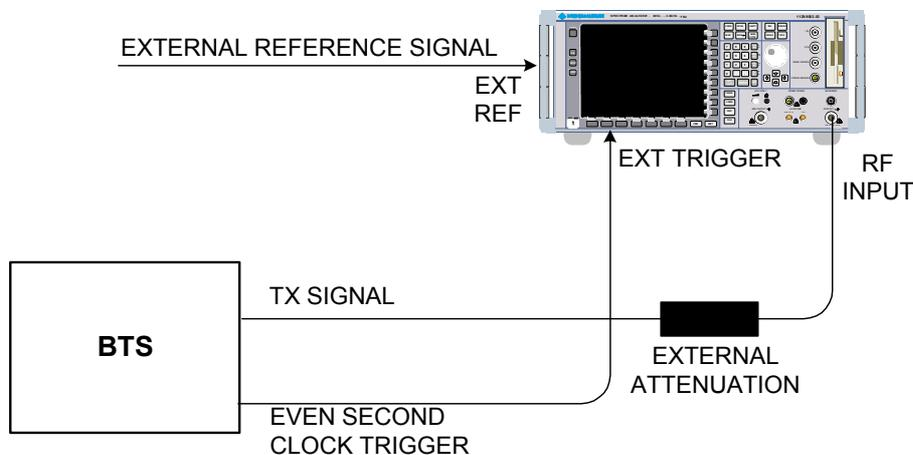
Bild 3-1 BTS Messaufbau
