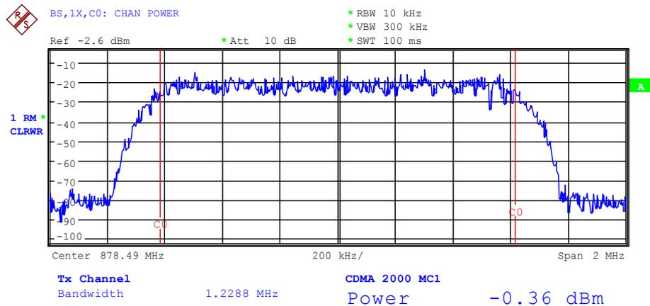
Bild 6-1 Messung der Leistung im 1.2288-MHz-Übertragungskanal
