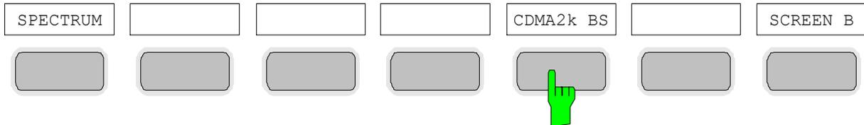
Bild 5-1 Hotkeyleiste mit freigeschalteter Applikations-Firmware R&S FS-K82
