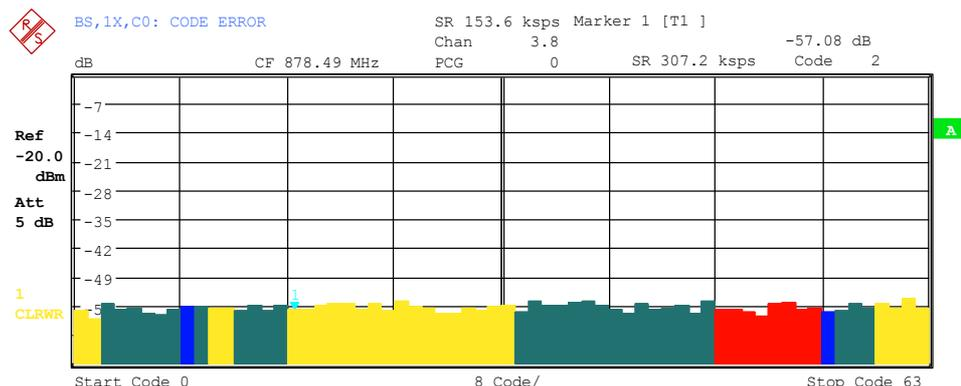
Bild 6-10 CDEP-Diagramm in BitReverse-Ordnung für das gleiche Signal
